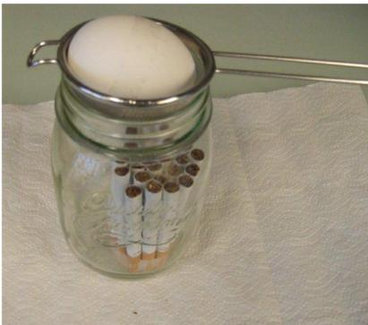
In ein leeres Konfitüreglas stellt man ca. 20 Zigaretten. Diese werden gleichzeitig angezündet. Über das Glas legt man ein Metallsieb, in dem sich ein hart gekochtes Ei befindet. Das Ei wird vorgängig mit einem kleinen Stück Klebestreifen an der dem Rauch ausgesetzten Seite versehen.
